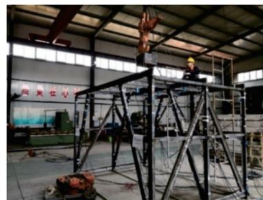
图9 冲击试验加载装置图
