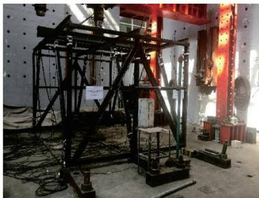
图10 静力试验加载装置图
