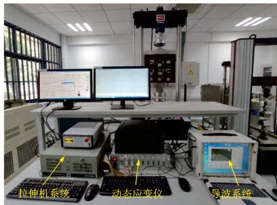
图3 载荷影响导波实验
