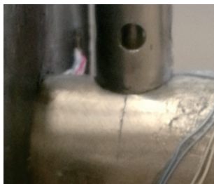
图13 测量耙根部裂纹分布
