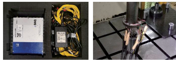
图 15 试验设备与齿毂应力-应变测试
