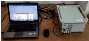
图 2 冰-砼碰撞实验动力及数据采集分析系统
