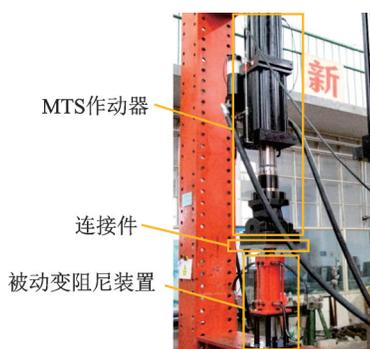
图 5 试验加载图
