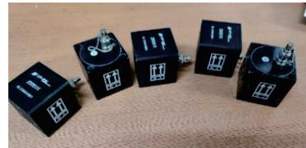
(b) 磁电式振动传感器
