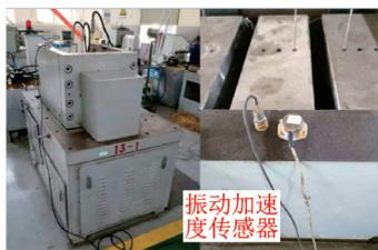
图 13 轴箱轴承试验台
