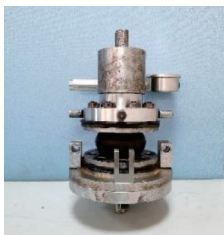
图 7 囊式分子弹簧隔振器装置图
