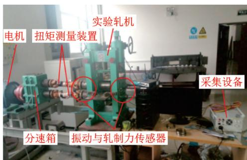
图2 板带轧机轴承故障诊断实验台
