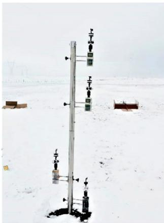
图 6 现场风速风向仪安装
