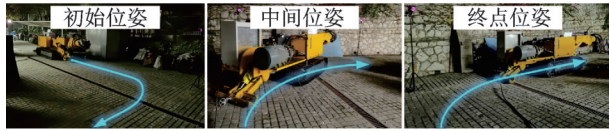
图8 掘进机试验轨迹
