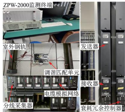
图6 ZPW-2000轨道电路试验平台
