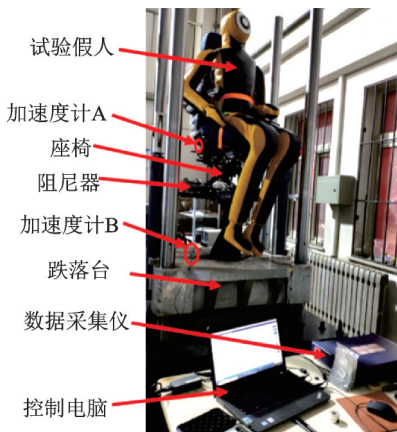
图 19 缓冲座椅跌落试验
