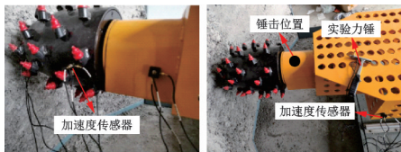
图 11 截割系统测点布置及力锤敲击实验
