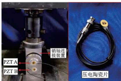
图6 销轴连接装置和压电陶瓷片
