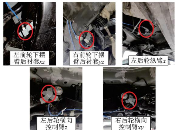
图 7 加速度计安装位置及测试方向
