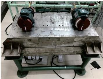
图7 两机驱动振动实验台
