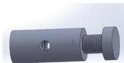
图5 进液套结构
