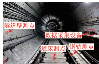
图4 隧道内轨道振动测点布置
