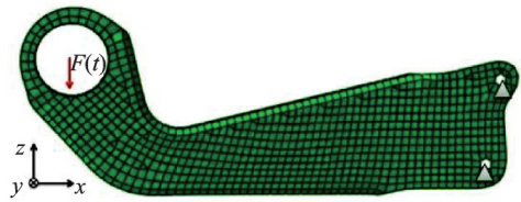
图5 拖曳臂有限元模型及约束示意图
