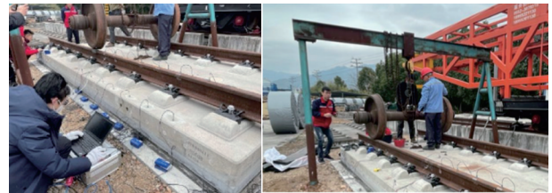
图4 落轴试验平台
