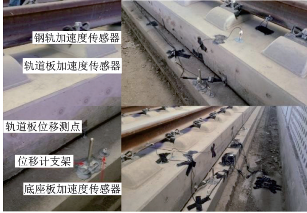
图 10 减振无砟轨道测点图
