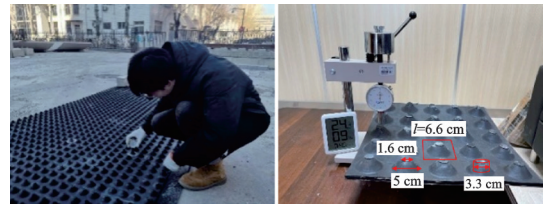
图3 室内外橡胶垫硬度测试
