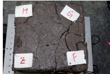
图11 部分融化土样表面裂隙状况
