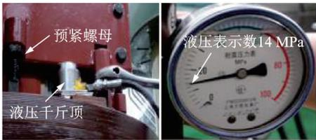
图 4 实验故障设置
