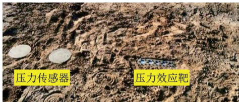
图3 静爆试验冲击波压力测试布场图
