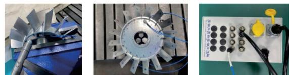
(a) 扇区叶盘测试 (b) 整体叶盘测试 (c) 信号采集模块
