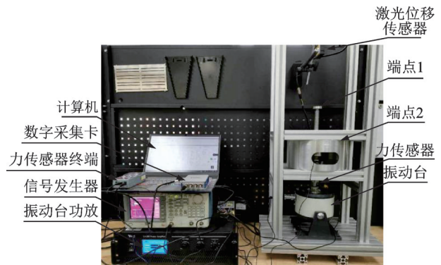
图8 滚珠丝杠惯容器虚实映射实验系统
