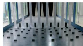
图3 地面粗糙度模拟装置
