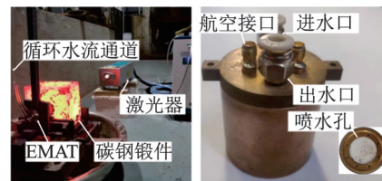
图14 高温铸锻件Laser-EMAT检测系统
