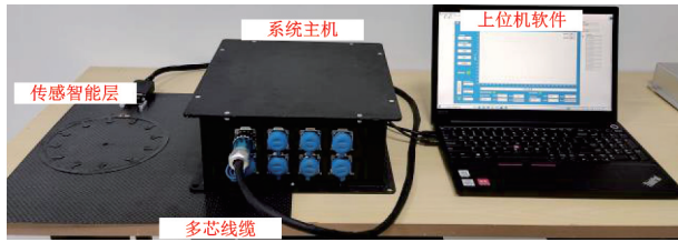
图15 测试系统 Fig.15 Test system
