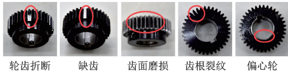
图 5 故障齿轮
