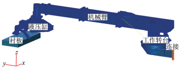
图1 某型液压重载机械臂有限元模型
