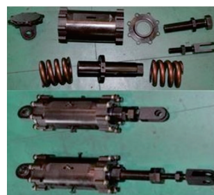
图 5 弹簧止扭装置零件及组件实物 Fig.5 Physical object of EATD
