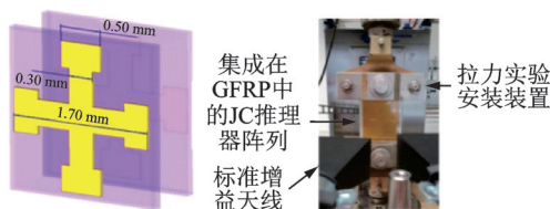
图 31 双层十字形超材料应变传感器
