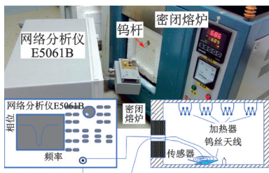
图 12 非共烧无线无源温度传感器测试平台 Fig.12 Non-co-fired wireless passive temperature sensor test platform
