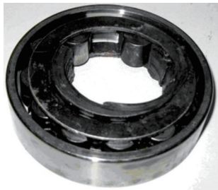
图 14 高线轧机轴承故障实物图
