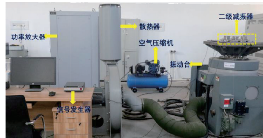
(a) 苏试振动试验台 (a) Sushi vibration test bench
