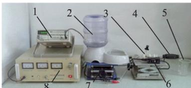
1-波形发生器; 2-水源; 3-压电泵; 4-流量计感测头; 5-烧杯; 6-流量计控制器; 7-升降台; 8-功率放大器
