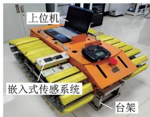
图15 台架试验布置
