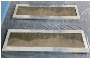
图 2 制备的煤岩体试件 Fig.2 Preparation of coal-rock specimens
