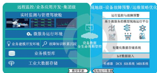
图3 大型旋转机组健康管理软件通用平台部署架构
