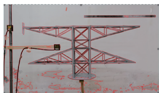
图2 输电塔内轮廓识别结果
