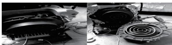
图 6 涡旋压缩机样机
