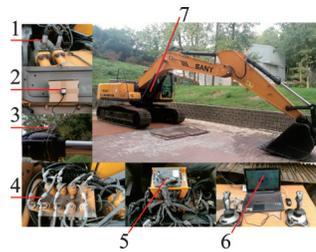
1-压力传感器;2-电子罗盘;3-拉线式位移传感器;4-主阀;5-DSP控制器;6-轨迹控制系统;7-SY-235 挖掘机器人
