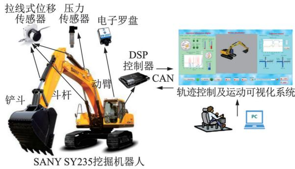
图1 挖掘机器人系统简图
