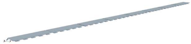
图 2 半潜式浮体水动力计算模型
