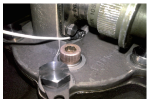
图6 传感器安装位置示意图
