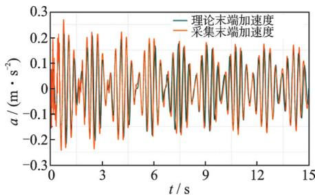
图13 无抑振时理论与实验加速度曲线
