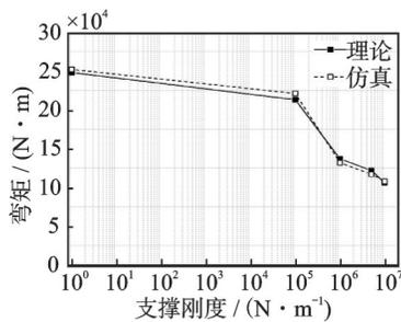
图6 不同刚度时瞬态的弯矩幅值
