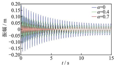
图 9 不同减振因子的抑振效果
