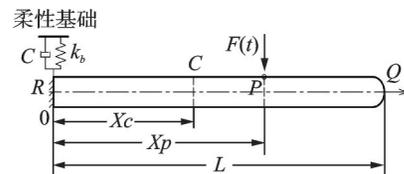
图8 带柔性基础的主动抑振模型
