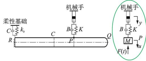
图 10 主动抑振机械手模型
