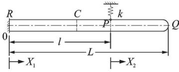
图1 弹性支撑悬臂梁模型
