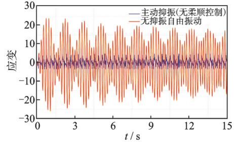
图14 自由振动和主动抑振的应变曲线
