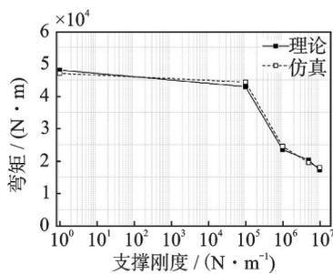
图7 不同刚度时稳态的弯矩幅值
