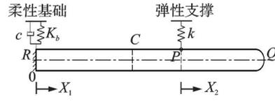
图4 被动减振模型
