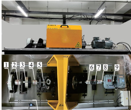
1-磁粉制动器; 2, 4, 6, 8-柔性联轴器; 3-变速箱; 5, 7-转速转矩传感器; 9-三相变频电机
