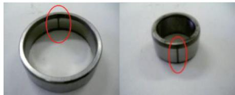
(a) 外圈故障 (b) 内圈故障
