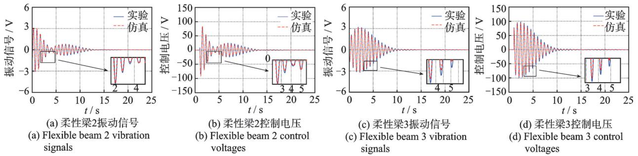
图5 柔性梁2,3振动响应曲线和控制曲线
