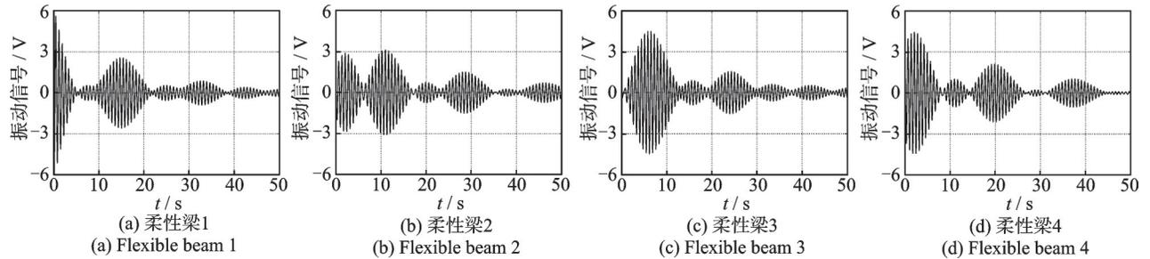
图6 柔性梁1~4的自由振动信号
