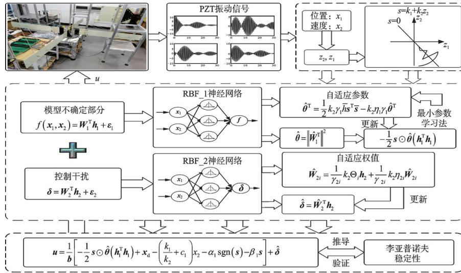
图3 RBF-BSSMC算法示意图
