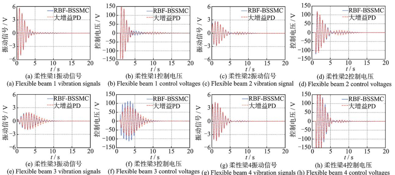
图7 RBF-BSSMC与PD的振动控制实验结果
