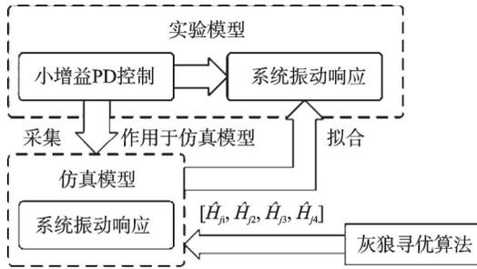
图2 辨识控制控制力系数流程
