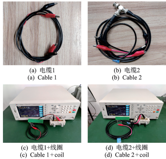
图8 线圈-BNC 电缆线阻抗测量
